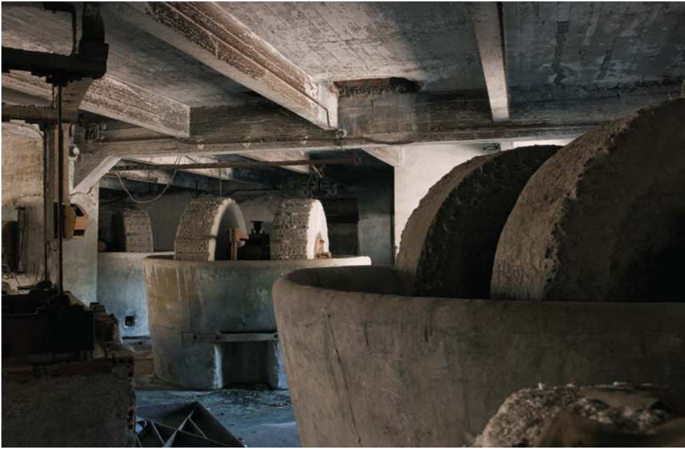
Hormigoi armatuko upa duten harrizko erroten xehetasuna; eraikinaren lehen solairuan daude. (Santi Yaniz) Detalle de los molinos de piedra con cuba de hormigón armado ubicados en la primera planta del edificio. (Santi Yaniz)
