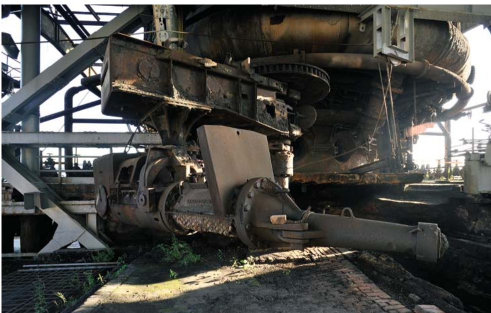
Labe garaiko tapa-pikeren kanoia. (Santi Yaniz) Cañón tapa-piqueras del horno alto. (Santi Yaniz)
