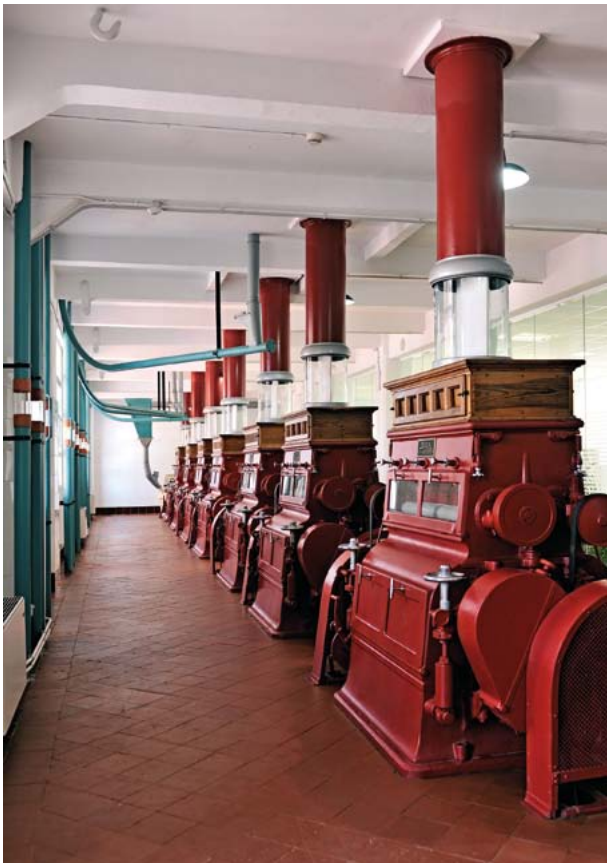
Zilindroetako errota bikoitzak, Alemaniako Seck enpresak 1912an eta 1920an eginak. (Santi Yaniz)
