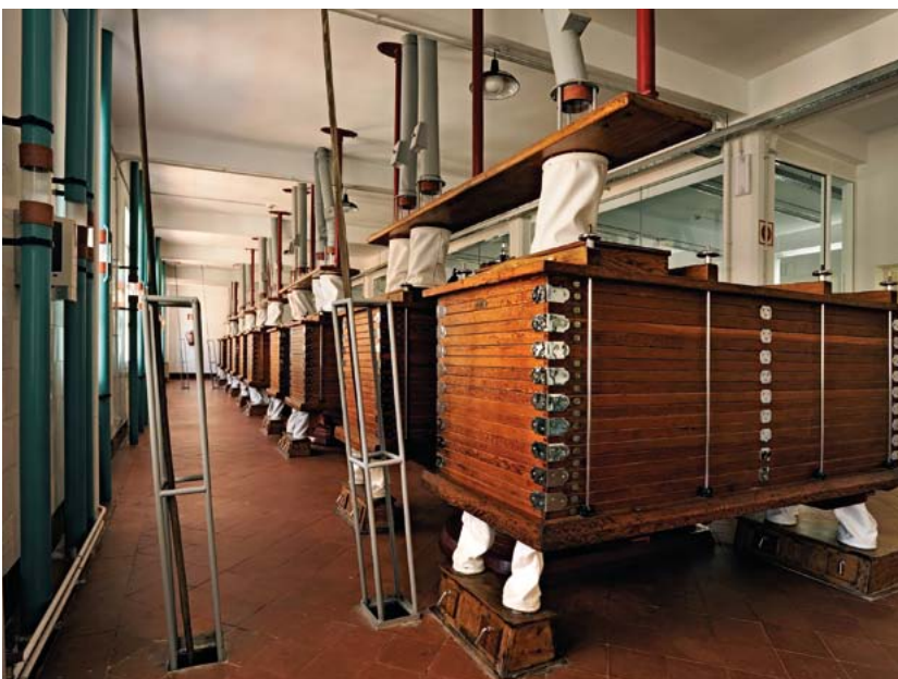
Makineria Harino Panaderaren legaturik balioetsuena da. Establecimiento Morros S.A.aren plansichter edo bahe multzoa. (Santi Yaniz)
