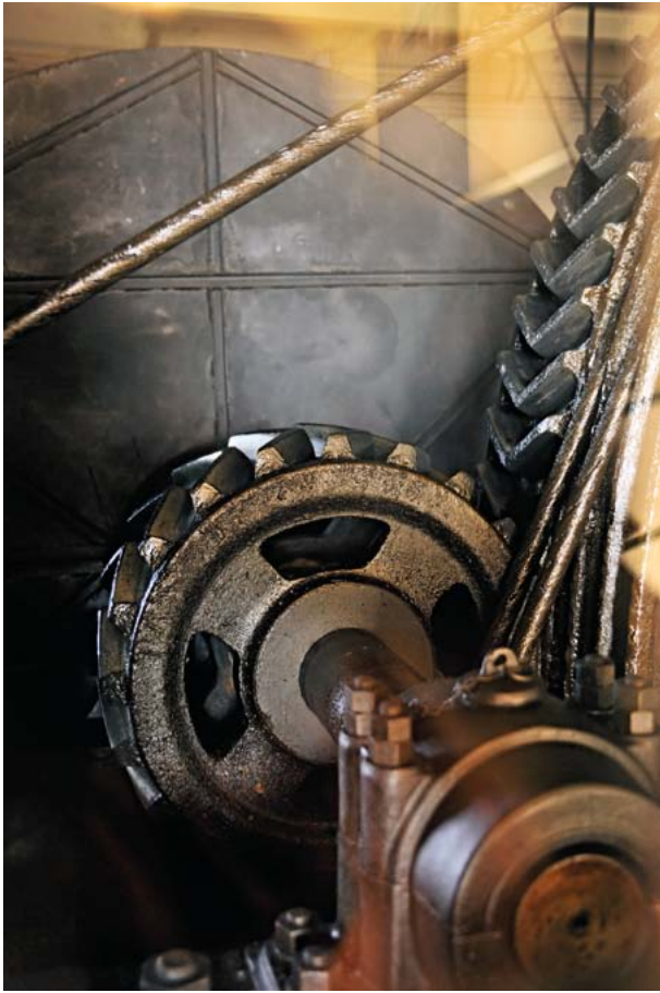
Funikularrak jatorrizko makineria dauka oraindik. Suitzako Von Roll enpresarena da martxan jartzeko gailua, eta hiru erreduktzioekin sortu zen. (Santi Yaniz) El funicular conserva la maquinaria original. El accionamiento procede de la casa suiza Von Roll y se concibió con tres reducciones. (Santi Yaniz)
