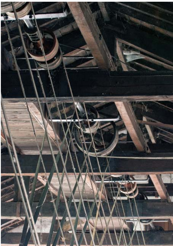
Ardatz horizontal zentralaren eta larruzko uhalen xehetasuna; uhalek eragin egiten zieten 24 estanpatzaileei lantegian. (Santi Yaniz)
